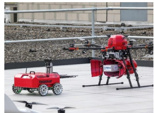
Beladung der Lieferdrohne von Emqopter durch den Emqopter Roboter EMQBot FOTO: EMQOPTER GMBH
